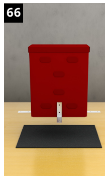
66 Zellkautschuk-Platte Zellkautschuk-Platte zwischen Schalungsbrett und FST-Kombibox SB zur Abdichtung auf die Deckenschalung kleben.
