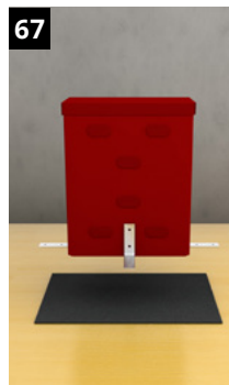
67 Zellkautschuk-Platte Zellkautschuk-Platte zwischen Schalungsbrett und FST-Kombibox SB zur Abdichtung auf die Deckenschalung kleben.
