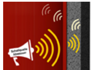
Schallreflexion an Schwererschicht der Dämmung
