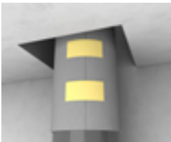
Schaumstreifen mit Klebestreifen um das Rohr befestigen.
