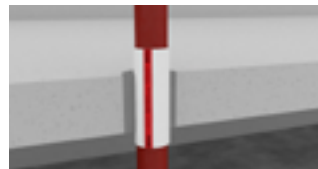
Regenwasser- und Feuerlöschleitungen aus Guss/Stahl
